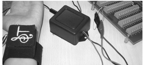
Fig. 5. Hardware del dispositivo de estimulación táctil. Sistema de vibración y brazaletes para la sujeción en el punto de estimulación.
