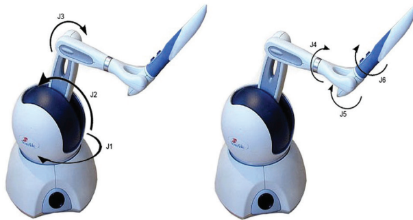
Fig. 3. Articulaciones del dispositivo háptico Omni-Phantom . Articulaciones motorizadas (J1, J2, J3), articulaciones no motorizadas (J4, J5, J6). [Tomado del sitio web de Sensable Technologies ]
