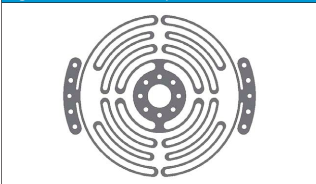
Fig. 5. Resorte torsional optimizado
