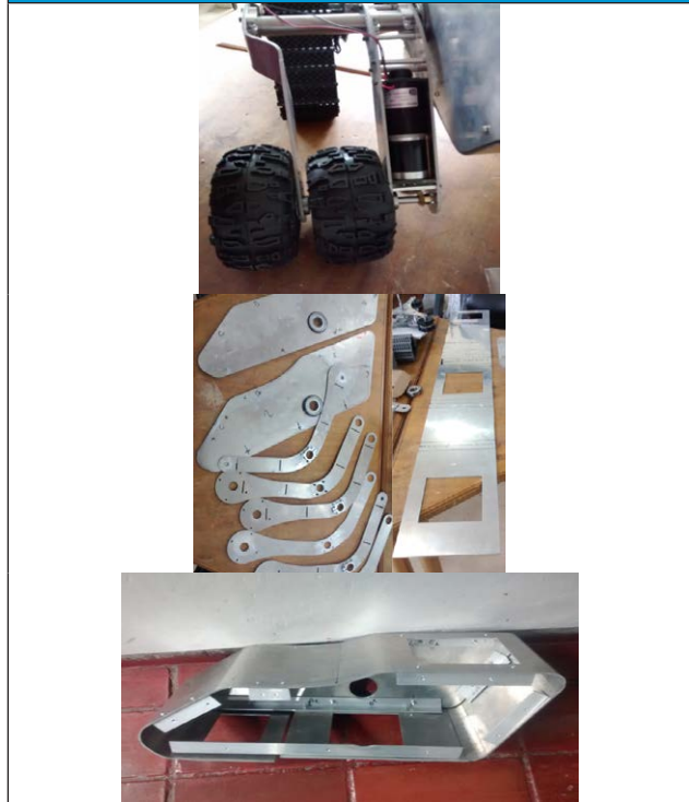
Fig.8. Arriba: Sistema trasero del prototipo, Centro: Láminas cortadas del prototipo, Abajo: Armazón del prototipo
