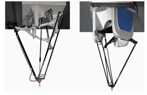
Fig. 2. Robot C23 y C33 de Deumareux.
