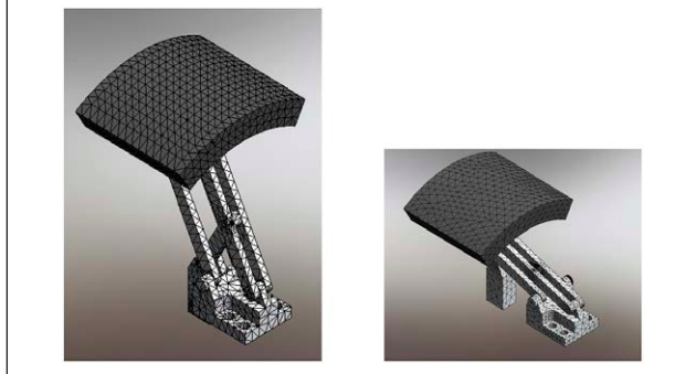
Fig. 10. Sistema de Análisis: Mallado, Imágenes tomadas en SolidWorks 2015. A) Entorno de 18 in. B) Entorno de 12 in.
