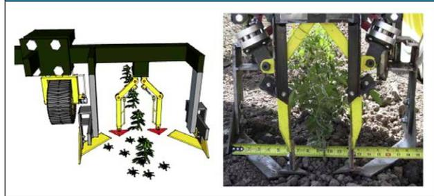
La apertura y cierre de las azadas está determinada por cilindros hidráulicos de doble efecto con carrera de 0,3m, los cuales son accionados por válvulas de control electro-hidráulico enlazadas a un panel de herramientas, permitiendo al usuario actualizar el registro de posición de la herramienta de corte, garantizando la precisión y reducción del error de posicionamiento.
