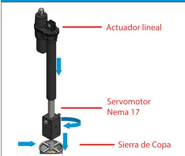
Con base en las especificaciones técnicas de los distintos elementos que componen el sistema de corte del prototipo, se calcula la velocidad de corte a partir de la ecuación 3, la cual indica la velocidad superficial en el diámetro. Este valor es necesario para determinar los datos de corte verdaderos a la profundidad de corte.
