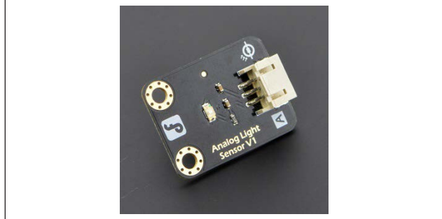
Fig. 9. Sensor de luminosidad LX1972. Imagen tomada de: http://es.aliexpress.com/w/wholesale-eye-sensitivity.html
