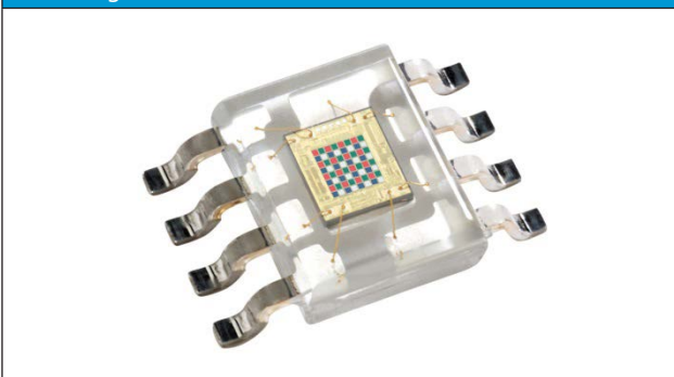
Fig. 8. Sensor de color TCS3200. Imagen tomada de: http://reibot.org/2011/07/06/tcs3200/
