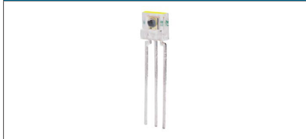
Fig. 10. Sensor TSL257 convertidor de luz en tensión. Imagen tomada de: http://shop.openenergymonitor.com/tsl257-optical-pulse-sensing-kit/
