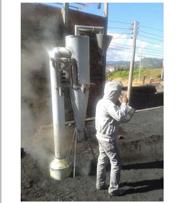
Fig. 12. Purificador ciclónico operando sobre el flujo emitido por una chimenea en un horno de coquización.
