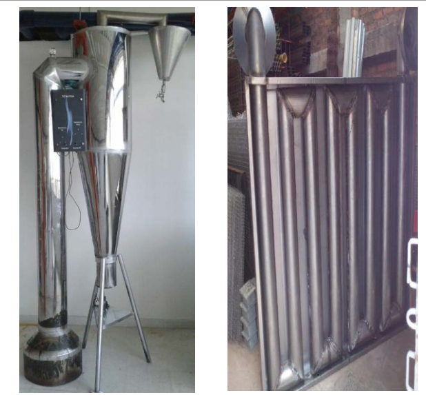
Fig. 10. Construcción final del ciclón separador de PM, Tratamiento de Gases y sistema de refrigeración.
