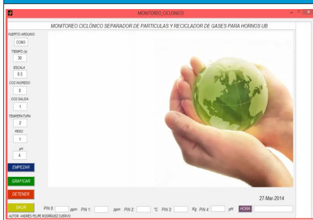
Fig. 8. Apariencia de la interface gráfica para manejar el registro y control de la operación del purificador ciclónico mediante la herramienta GUI de Matlab.
